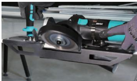
Krok 2. Udržujte ložisko v těsné blízkosti opřené a posuvné na okraji dlaždice/ obkladu (desky)
